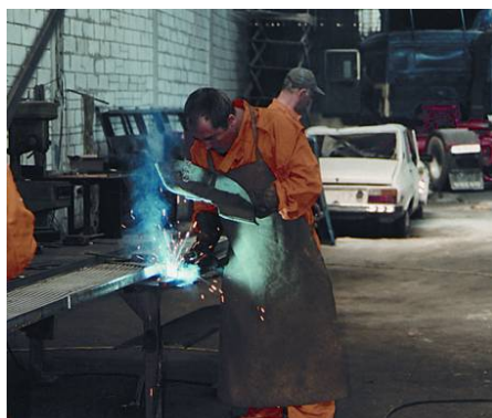
emisia de fum de la sudură.
