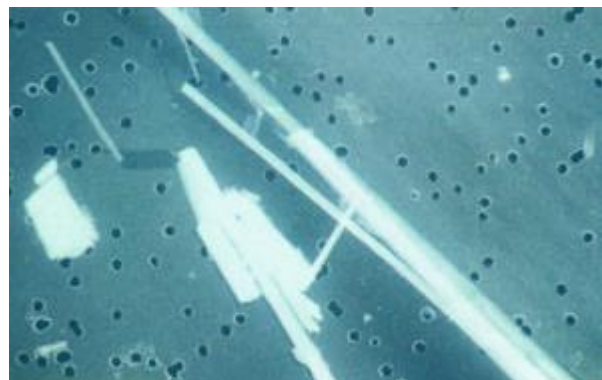
Fibre și fibrile de azbest văzute la microscop (amozit 8000)
